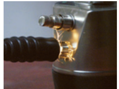
De POWERCELL PDX load cell wordt in een laboratorium getest met behulp van een gesimuleerde blikseminslag.
