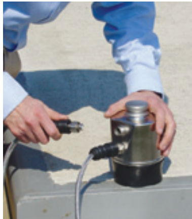
Quick-connect load cell kabels zijn onderdeel van het stabiele, afgedichte POWERCELL PDX netwerk.
