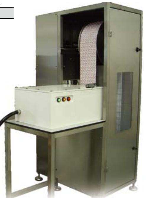
Bandoleer X-ray systeem aangesloten op een carrousel voor productinspectie
