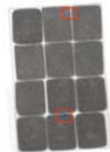
Staal van 0,8 mm en glas van 2 mm gedetecteerd in een doos met bouillonblokjes
