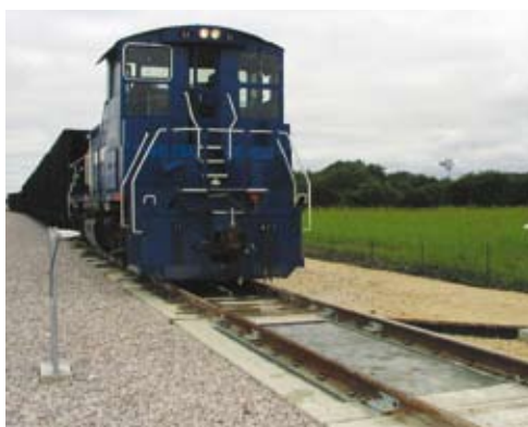
CIM-railweegschalen wegen de goederenwagons die aan elkaar zijn gekoppeld en over de weegbrug gaan.
