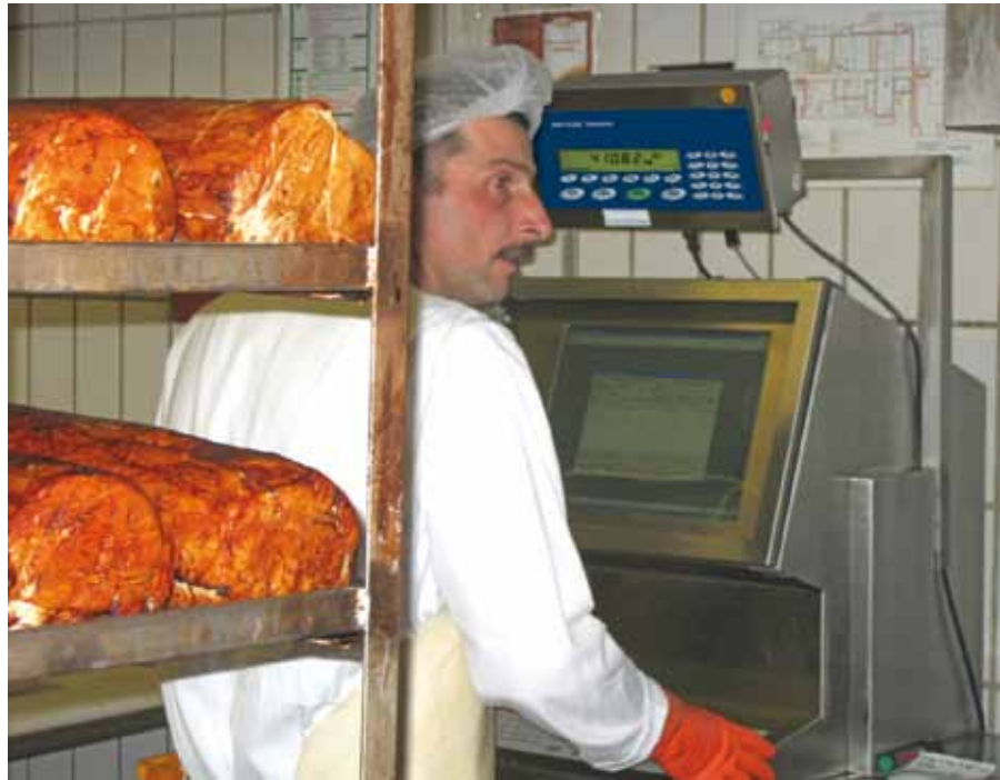
De weegterminal van METTLER TOLEDO communiceert direct met het productieplanning en -beheersysteem (PPS) van CSB. Iedere productiestap wordt in detail gedocumenteerd.
