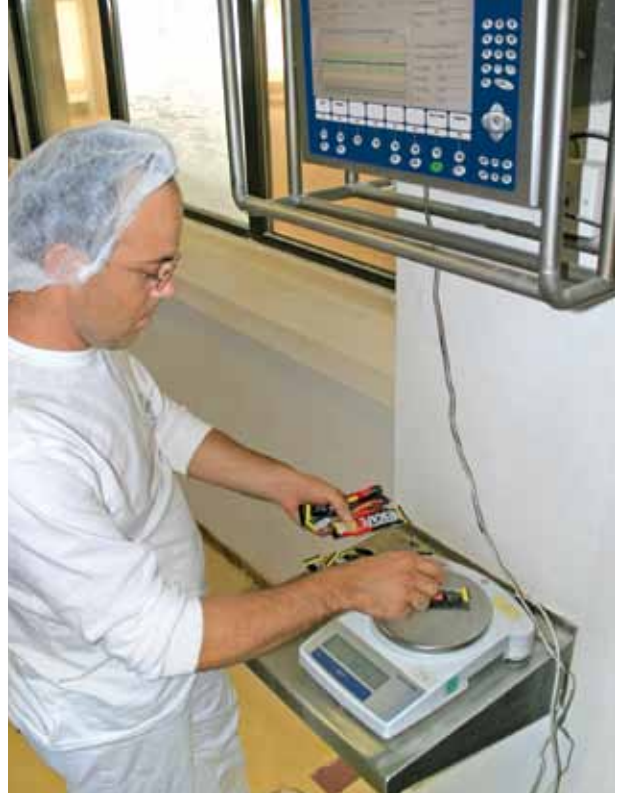
Controle op netto-inhoud van Nescafe-sticks, Maggi-bouillonblokjes en Chokella-pasta bij de FreeWeigh.Net®-testlocaties met de ID30-PC-weegterminal
