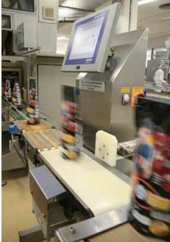
Garvens dynamische checkwegers geïntegreerd in FreeWeigh.Net®
