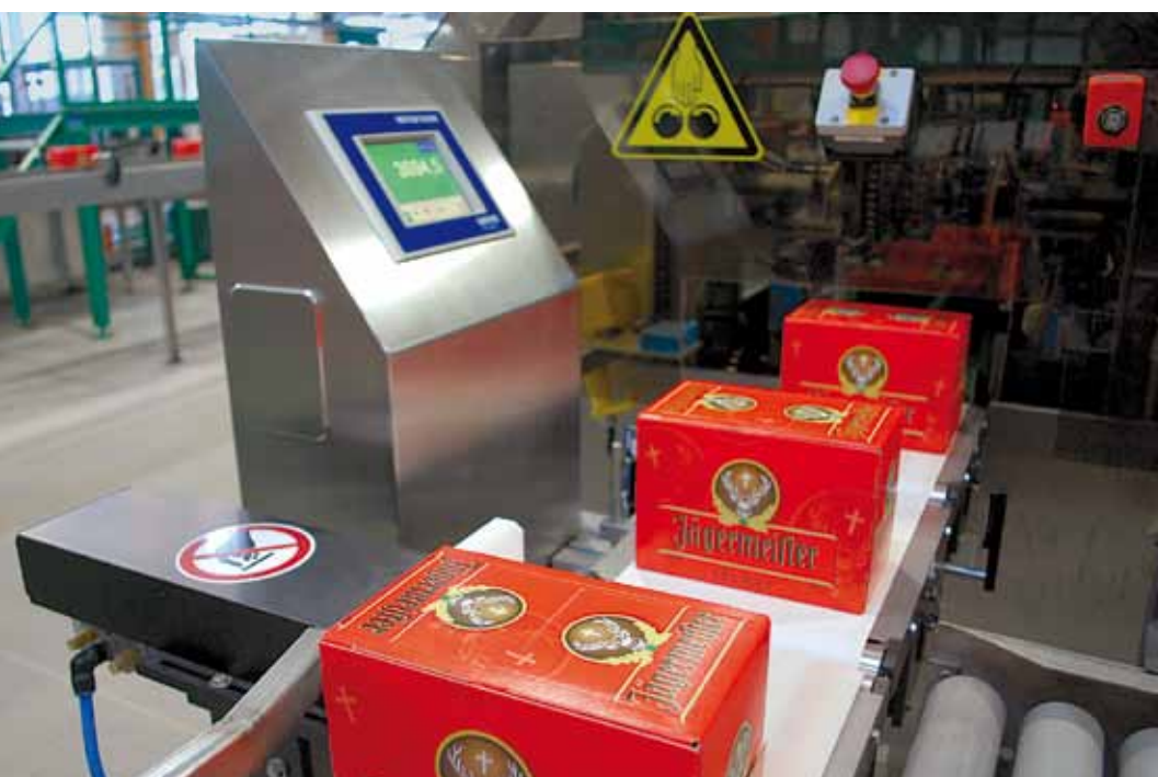
Controleweger XE3 controleert of de dozen met flessen compleet zijn.
