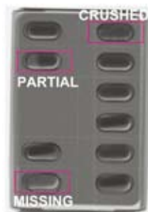
Blisterpak met een gedeeltelijke, een geplette en een ontbrekende tablet
