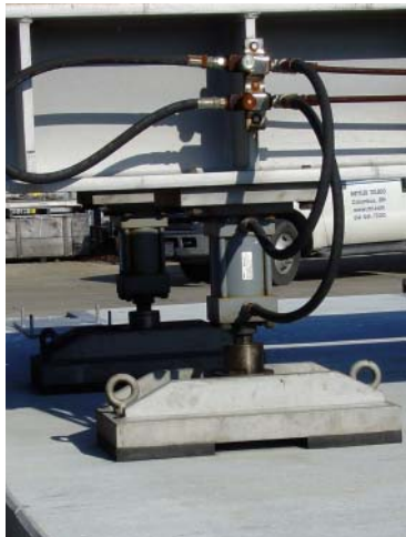
Elke voet is uitgerust met twee rubber kussens met dezelfde tussenruimte als een paar banden.
