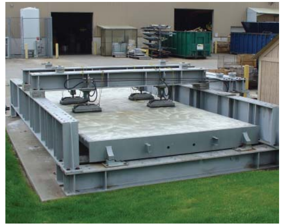
De module-stamper test weegbrugmodules door simulatie van 20 jaar verkeer binnen 2 maanden.
